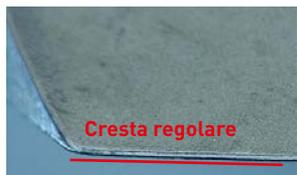
Nuova lavorazione del tagliente per CFRP
